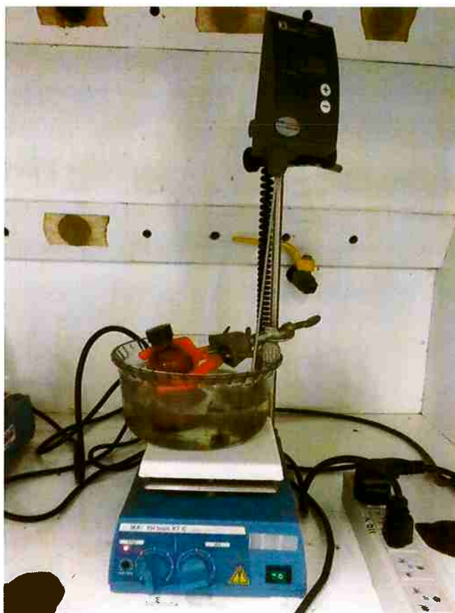
Figura 8 - Solução no banho de óleo a aproximadamente 65°C com agitador magnético
