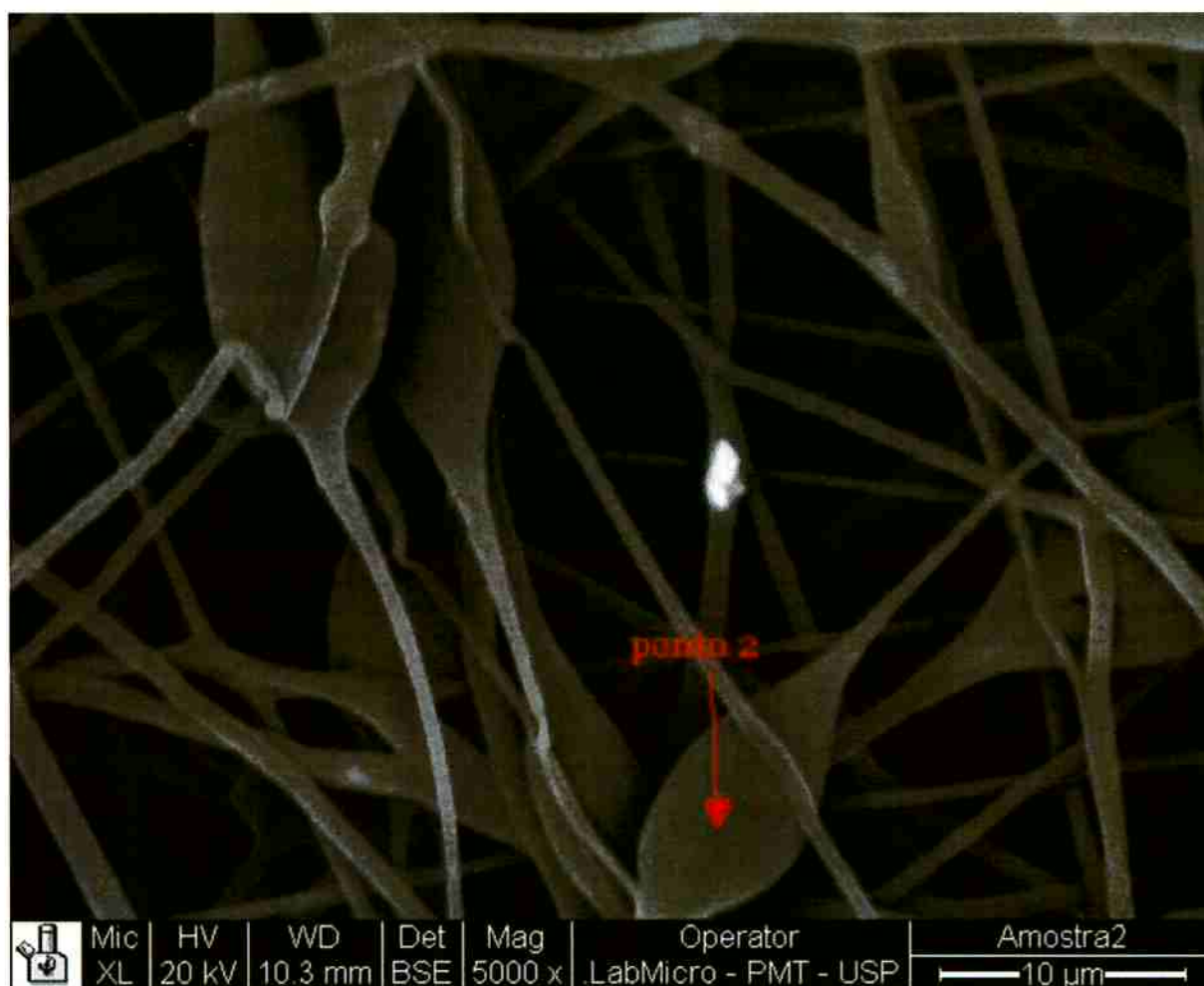
Figura 37 - Ponto 2 da manta eletrofiada a partir da amostra 2 analisado para verificar presença de prata
