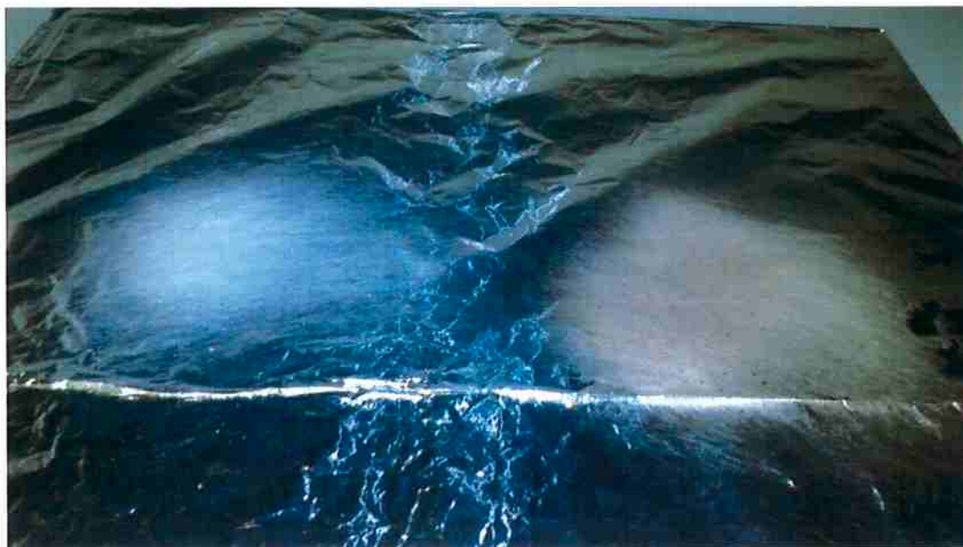
Figura 14 - Duas mantas eletrofiadas no mesmo substrato de alumínio. A mancha branca na esquerda é uma manta recém eletrofiada e a mancha amarronzada é uma manta eletrofiada após algumas horas
