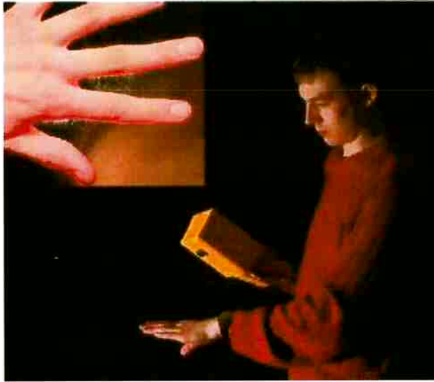
Figura 7 - Aparelho portátil para eletrofição de curativo para feridas. No canto superior esquerdo: fibras de PEO eletrofiadas a partir de solução aquosa na mão de uma pessoa
