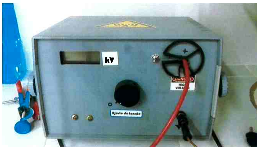
Figura 12 - Fonte de alta tensão
